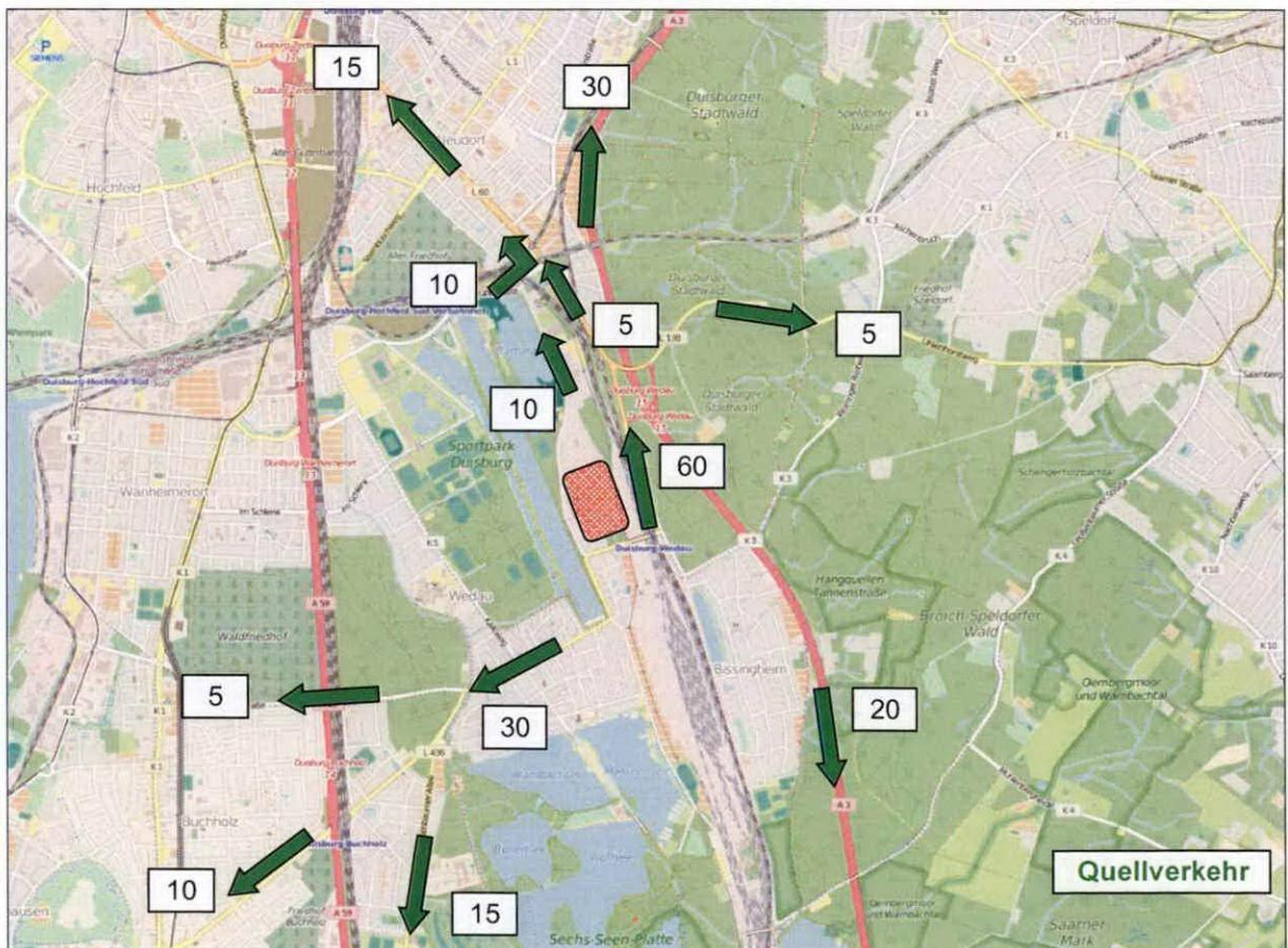
**Abbildung 3:** Prozentuale Verteilung des Zusatzverkehrs [%] im Ziel- und Quellverkehr mit Bezug zum umgebenden Straßennetz für die gewerblichen Nutzungen der Teilfläche Nord (Kartengrundlage: openstreetmap.org)
